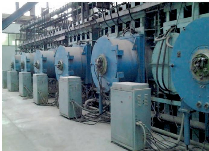
Высоковакуумные станции на базе геттерных насосов
