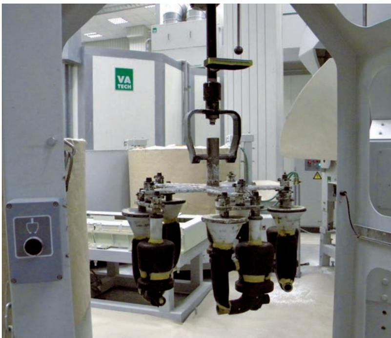
Подвеска для одновременного изготовления пяти форм детали «Корпус» ракетносителя «Протон»
