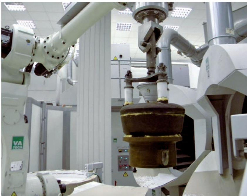
Модельный блок перед запуском изготовления формы отливки детали насоса двигателя ракетноносителя «Протон»
