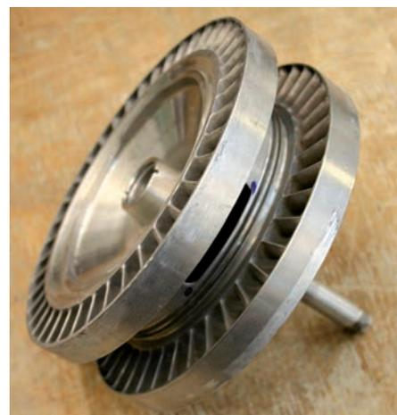
Литая деталь «Ротор», с литыми бесприпусковыми лопатками, стартера запуска авиационного двигателя ПС-90А. Материал – высокопрочная нержавеющая сталь ВНЛ-5. Скорость вращения на стадии запуска  $p=40000 - 45000$  об/мин.
