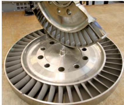
Ротор турбины двигателя первой ступени ракетносителя «Протон», с литыми бесприпусковыми лопатками. Материал – никелевый сплав ЖС6К-ВИ. Скорость вращения в момент пуска до 20000 об/мин. Наружный диаметр – 320 мм. Вес заготовки – 10,8 кг
