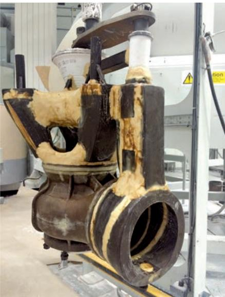
Модельный блок отливки детали «Патрубок» двигателя «РД-285». Материал – высоколегированная коррозионностойкая сталь ЭП-56Л. Вес заготовки – 38 кг
