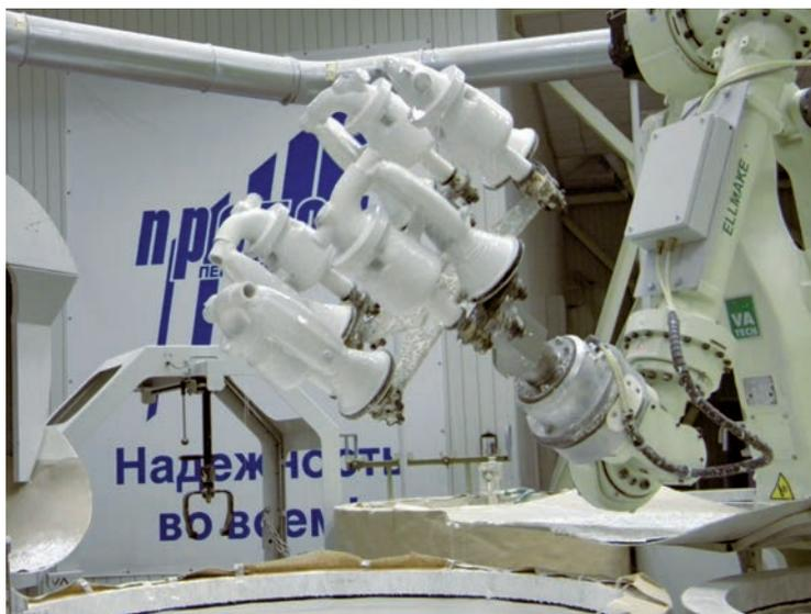
Модельные блоки после нанесения огнеупорного покрытия. Подвеска – пятиместная. Деталь – «Корпус» ракетносителя «Протон»
