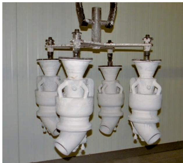
Подвеска с четырьмя формами после нанесения четырех слоев покрытия. Деталь насоса двигателя первой ступени ракетносителя «Протон»
