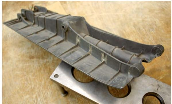
Створка регулируемого сопла авиационного двигателя ПС-90А. Габариты детали – 170x400 мм. Толщина полотна – 0,8мм. Материал – никелевый сплав ВЖЛ-14ВИ. Вес детали – 1,42 кг
