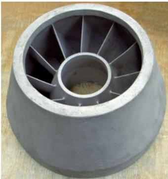
Отливка детали «Аппарат спрямляющий» ракетносителя «Ангара» с литыми лопатками. Материал – высокопрочная нержавеющая сталь ВНЛ-1. Вес литой заготовки – 13 кг. Наружный диаметр – 300 мм
