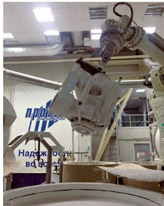
Нанесение огнеупорной суспензии на блок отливки детали «Патрубок» двигателя «РД-285» на робототехническом комплексе
