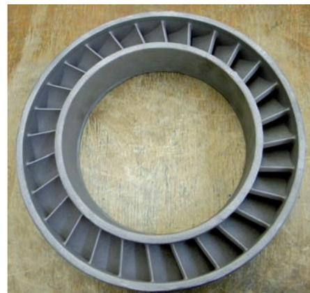
Стартер с литыми бесприпусковыми лопатками двигателя первой ступени ракетносителя «Протон». Материал – никелевый сплав ЭП-202. Наружный диаметр – 320 мм. Вес литой заготовки- 7,8 кг
