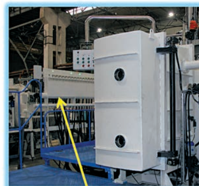
Коллектор напорно-сливной с точками контроля воды на камеру вакуумную, блок шлюзовой
