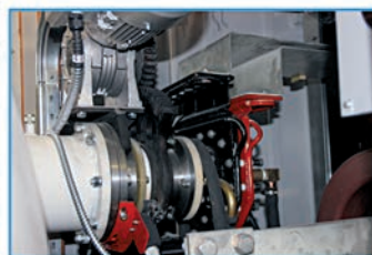
Применение усиленного щёточного механизма с увеличенной площадью контакта медно-графитовых колец
