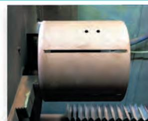
Поверхность изделия после наружного плазменного напыления
