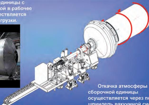
Откачка атмосферы из полости сборочной единицы осуществляется через полый шпindelь вакуумной системы устройства загрузки-выгрузки.
