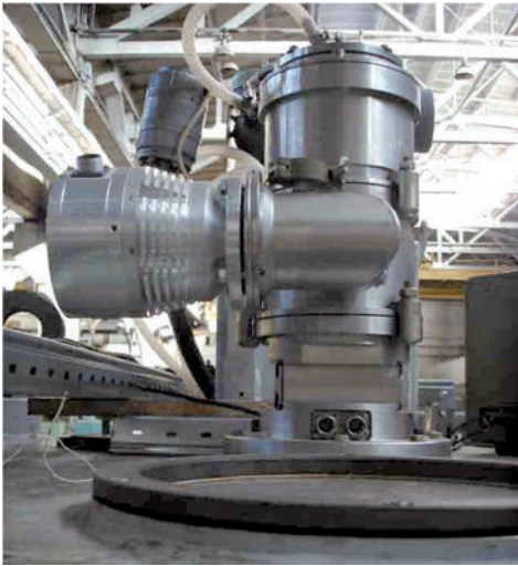
Электронно-лучевая пушка установки «СЭЛС-1»
