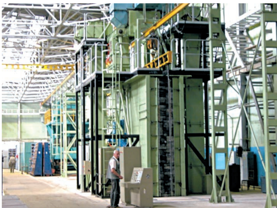
Установка дробемётного упрочнения поверхностей
