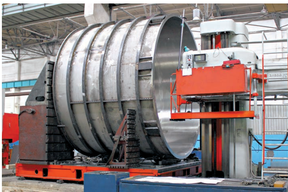
Механическая обработка фланцев секции вакуумной камеры испытательного стенда
