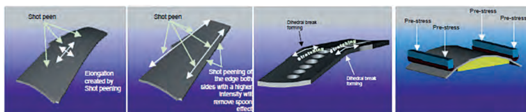
а) Способы ДУФ деталей типа обшивок, применяемые за рубежом: а) схема формоизменения листовой детали при односторонней дробеобработке; б) уменьшение (устранение) продольной кривизны детали обработкой продольных кромок; растяжение кромок (в) и заневоливание детали (г) при формообразовании зоны перегиба
