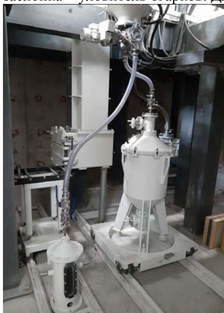
Рисунок 12. Механизм сбора огарков.
