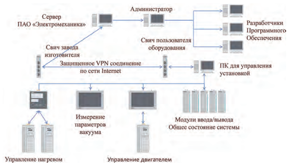
Обзор структуры системы управления и удаленного доступа
