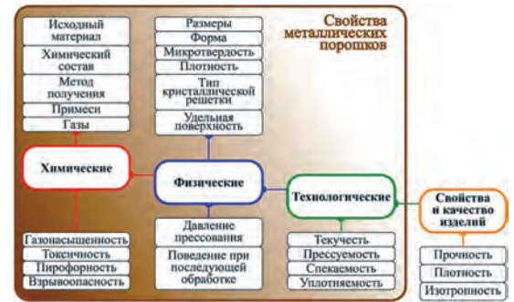
Классификация физических, химических и технологических свойств порошка
