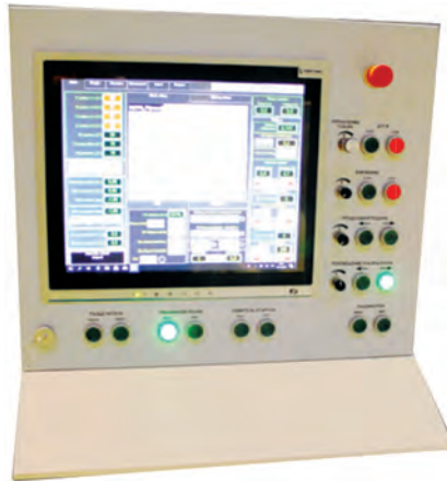
Пульт системы управления на базе компьютера
