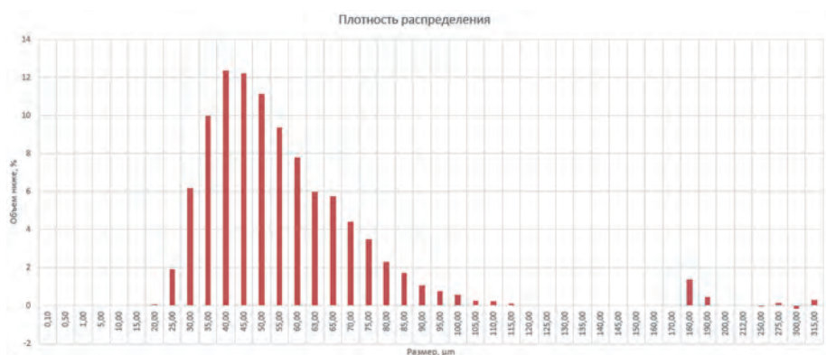
Распределение порошка из сплава ЭП741НП по размеру
