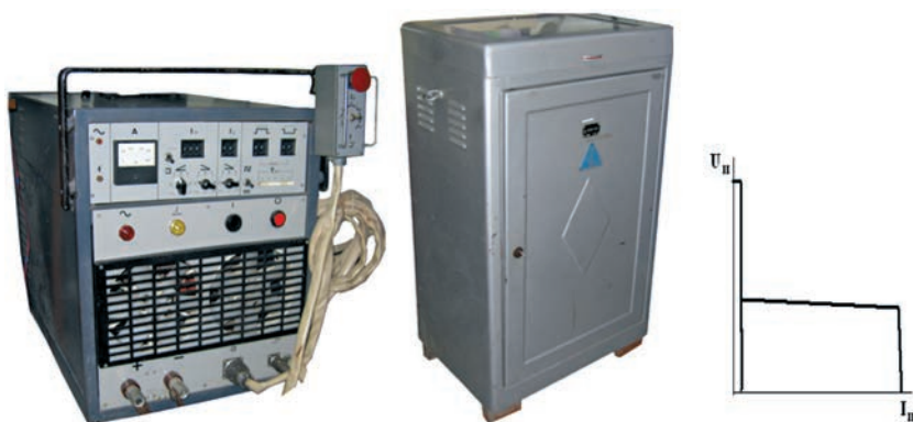
Внешний вид сварочного выпрямителя ВСВУ-400, ВСВУ-160 и внешние вольтамперные характеристики
