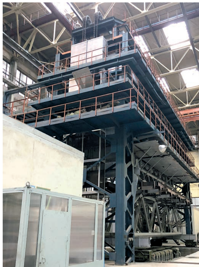
Установка ЭТА-15 для термообработки длинномерных деталей из алюминиевых сплавов
