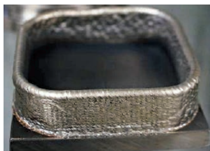
Внешний вид изделия (а – после послойного синтеза, б – после механической обработки), предоставлено компанией Steigerwald Strahltechnik GmbH
