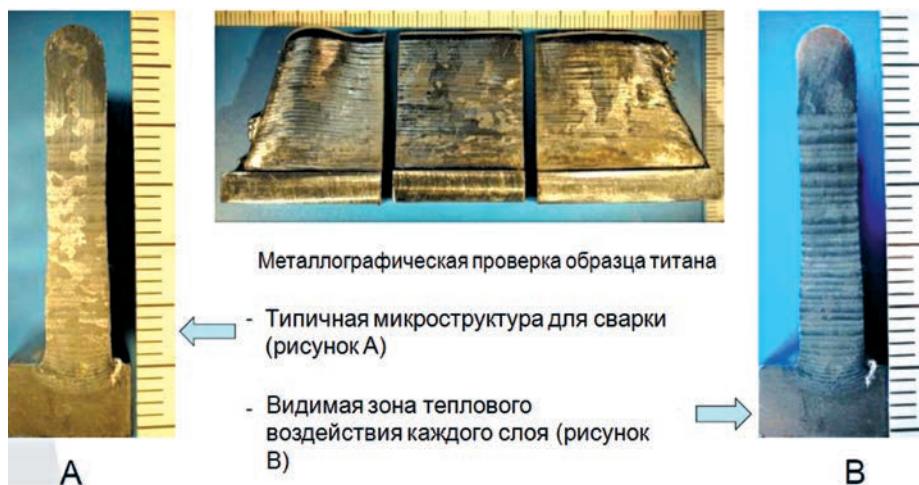
Микроструктура образцов, полученных по технологии EBAM (предоставлено компанией Steigerwald Strahltechnik GmbH)
