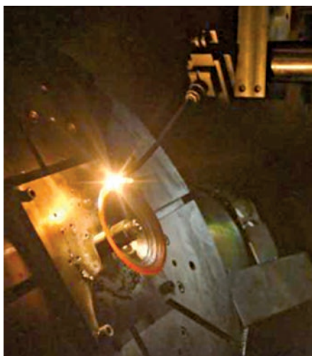
Синтез изделия из стальной проволоки по технологии EBAM (скорость наплавки – 8 мм/с, скорость подачи проволоки – 27 мм/с, диаметр проволоки – 1,0 мм, ускоряющее напряжение – 150 кВ, ток пучка – 3-4 мА, производительность – 46,1 см 3 /час), предоставлено компанией Steigerwald Strahltechnik GmbH)
