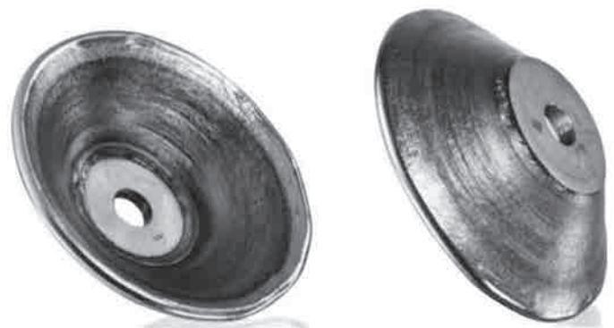
Синтез изделия из стальной проволоки по технологии EBAM (скорость наплавки – 8 мм/с, скорость подачи проволоки – 27 мм/с, диаметр проволоки – 1,0 мм, ускоряющее напряжение – 150 кВ, ток пучка – 3-4 мА, производительность – 46,1 см 3 /час), предоставлено компанией Steigerwald Strahltechnik GmbH)
