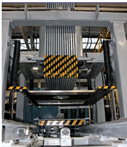
Подъемная плита опущена Силовая рама и Рабочая камера в рабочем положении
