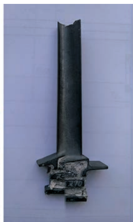
Лопатка в разрезе с керамическим стержнем
