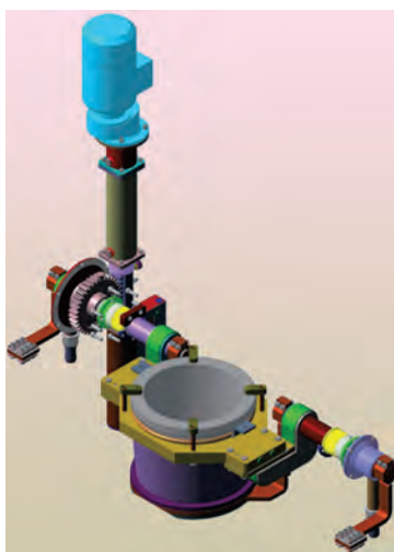
Регулируемый электромеханический привод наклона тигля
