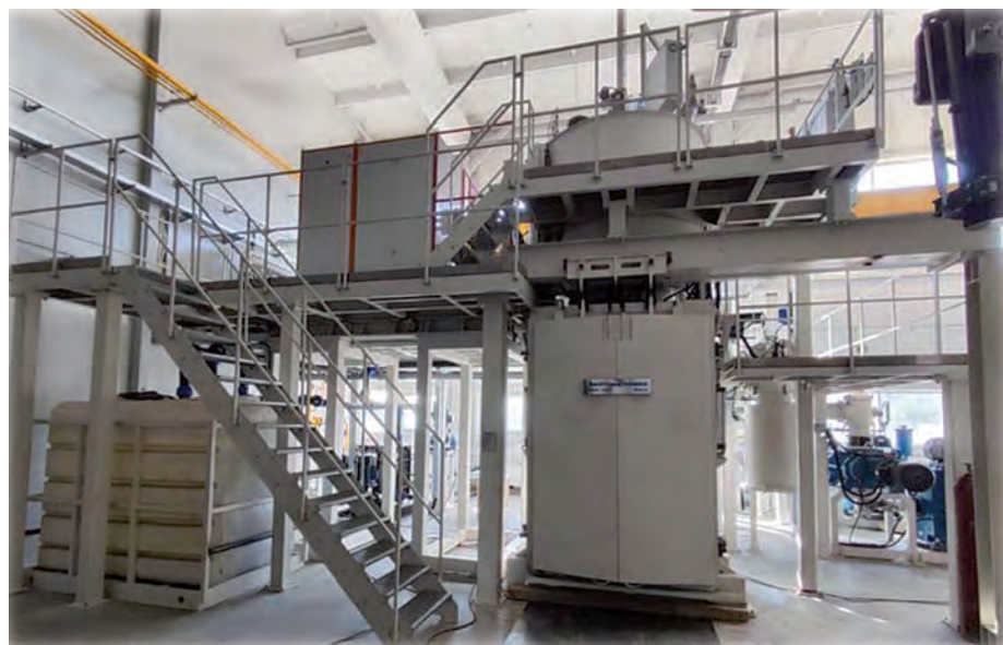
Вакуумная индукционная печь УВП-160 для крупногабаритного литья без печи подогрева форм
