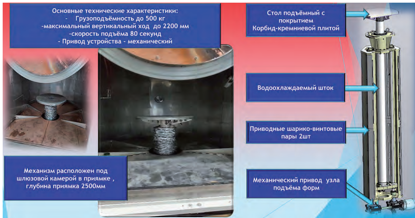
Механизм подъёма форм под заливку винтового типа
