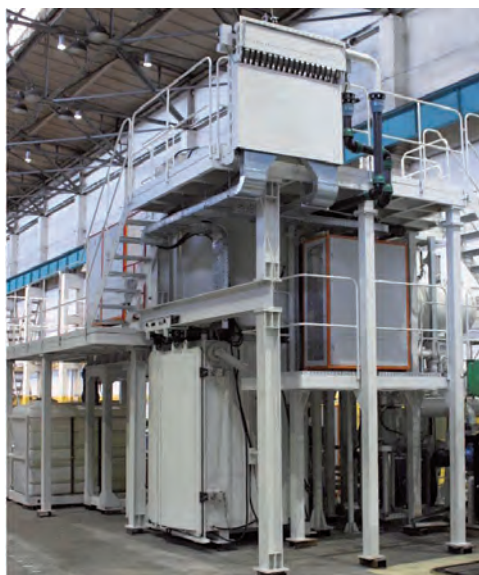
Вакуумная литейная установка УВПП-120 с печью подогрева форм для крупногабаритного литья
