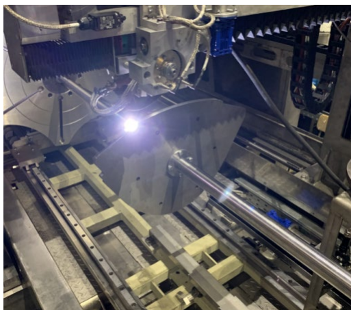
Рис. 30. Процесс сварки (взаимосвязанное перемещение по механическим осям)
