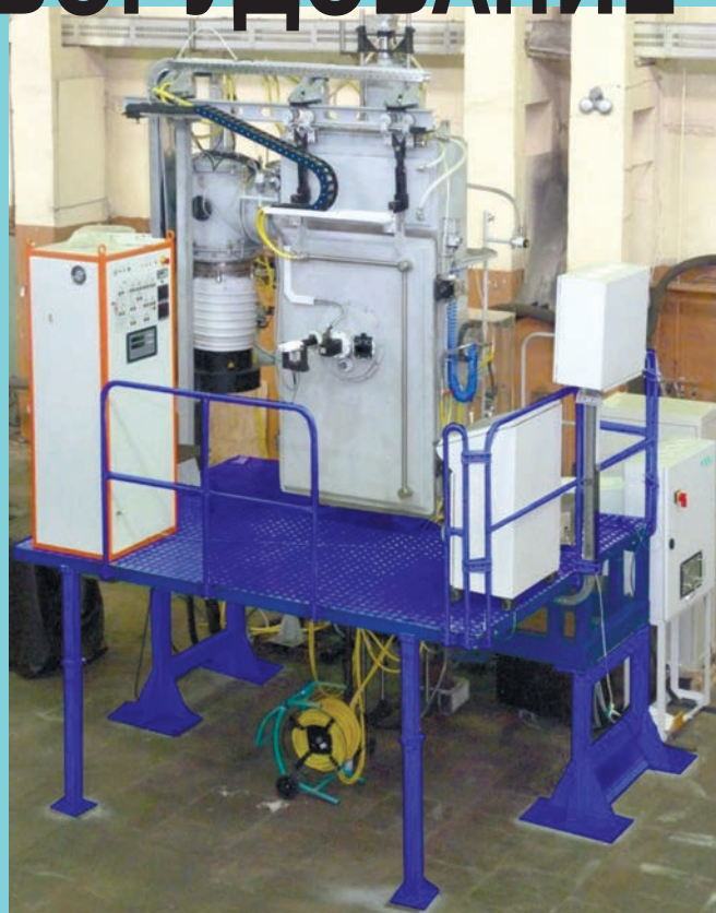
Установка для бестигельной зонной плавки электронным лучом (БЗП)
