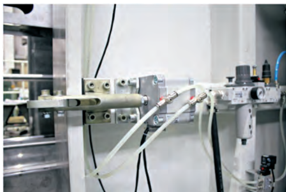
Пневматические зажимы откатной крышки
