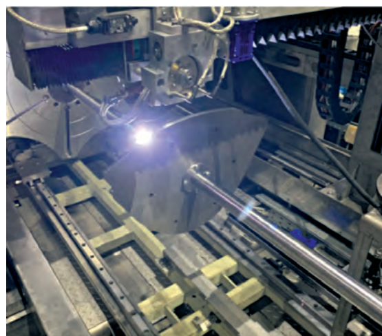
Процесс сварки (взаимосвязанное перемещение по механическим осям)
