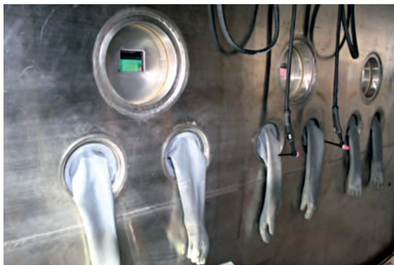
Перчаточные вводы для ручной сварки
