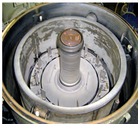
Рабочая вакуумная цилиндрическая камера напыления
