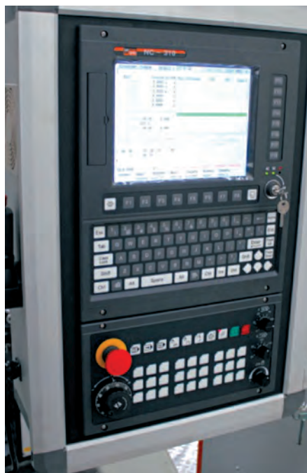
Пульт оператора на базе устройства ЧПУ NC-310
