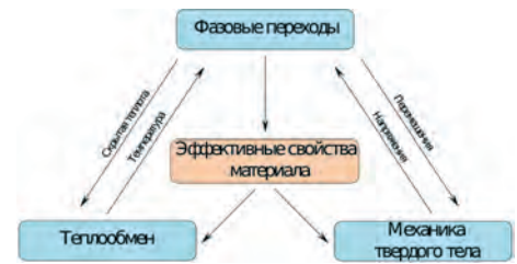
Моделирование фазовых превращений, сопряженных с теплопередачей и механикой твердого тела
