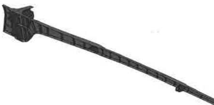
Внешний вид лонжерона, полученный методом послойной электронно-лучевой наплавки
