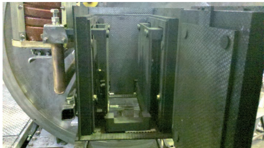
3D-модель и рабочий образец печи подогрева форм производства компании «ГрафитЭл» для установки ВИП-НК
