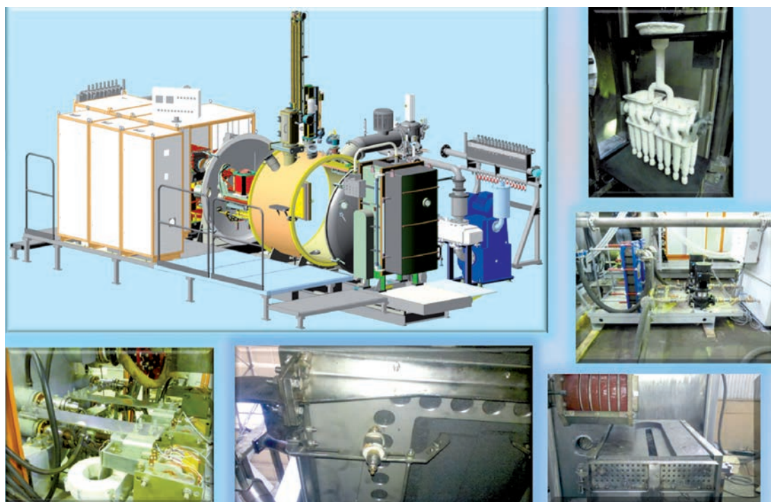
Особенности конструкции вакуумной индукционной печи типа ВИП-НК-ПМ
