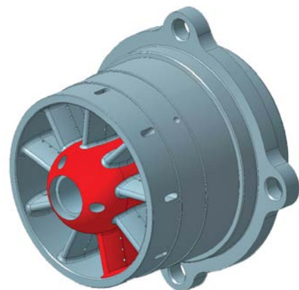
Модель завихрителя. Красным цветом указаны зоны, в которых необходимо придание поверхности повышенных жаропрочных свойств
