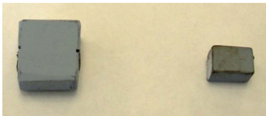
Образцы №1 и №2, полученные методами послойного электронно-лучевого синтеза из порошка титанового сплава ВТ6 и электронно-лучевого напыления металлического слоя из сплава NiCoCrAlY и керамического слоя ZrO_2 + 8\%Y_2O_3
