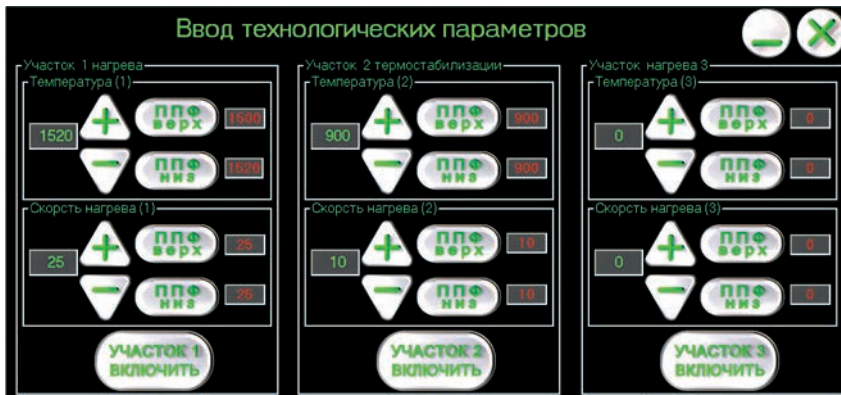
Рис. 3. Ввод управляющей программы нагрева ППФ
