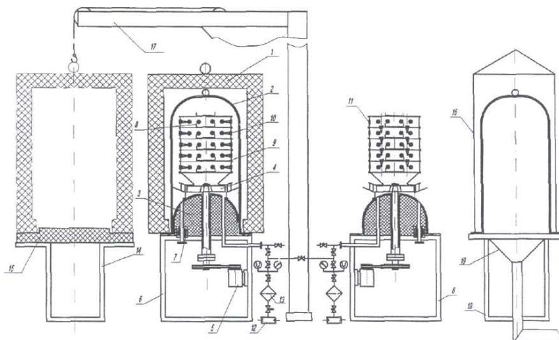
1000°C, обеспечивает формирование хромового покрытия, прочно сцепленного с основой через промежуточный слой сплава Fe-Cr с содержанием хрома до 30%. Преимущества метода - малая пористость покрытий и возможность металлизации внутренних поверхностей и деталей сложной конфигурации, недостаток - низкая производительность, обусловленная диффузионными процессами или химическими реакциями на поверхности раздела.
